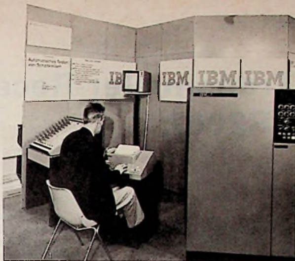
Afb. 15. IBM System/7 hier toegepast als automatische tester voor elektronische circuits.
